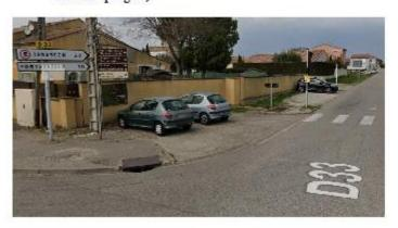
sur 63 ml, busage du fossé en diam 600 (identique à l'existant vers l'exutoire qui est déjà en 600), création d' un trottoir d'environ 2,2 m et un stationnement longitudinal de 2,6 m en moyenne, mise en place de grilles pluviales.
