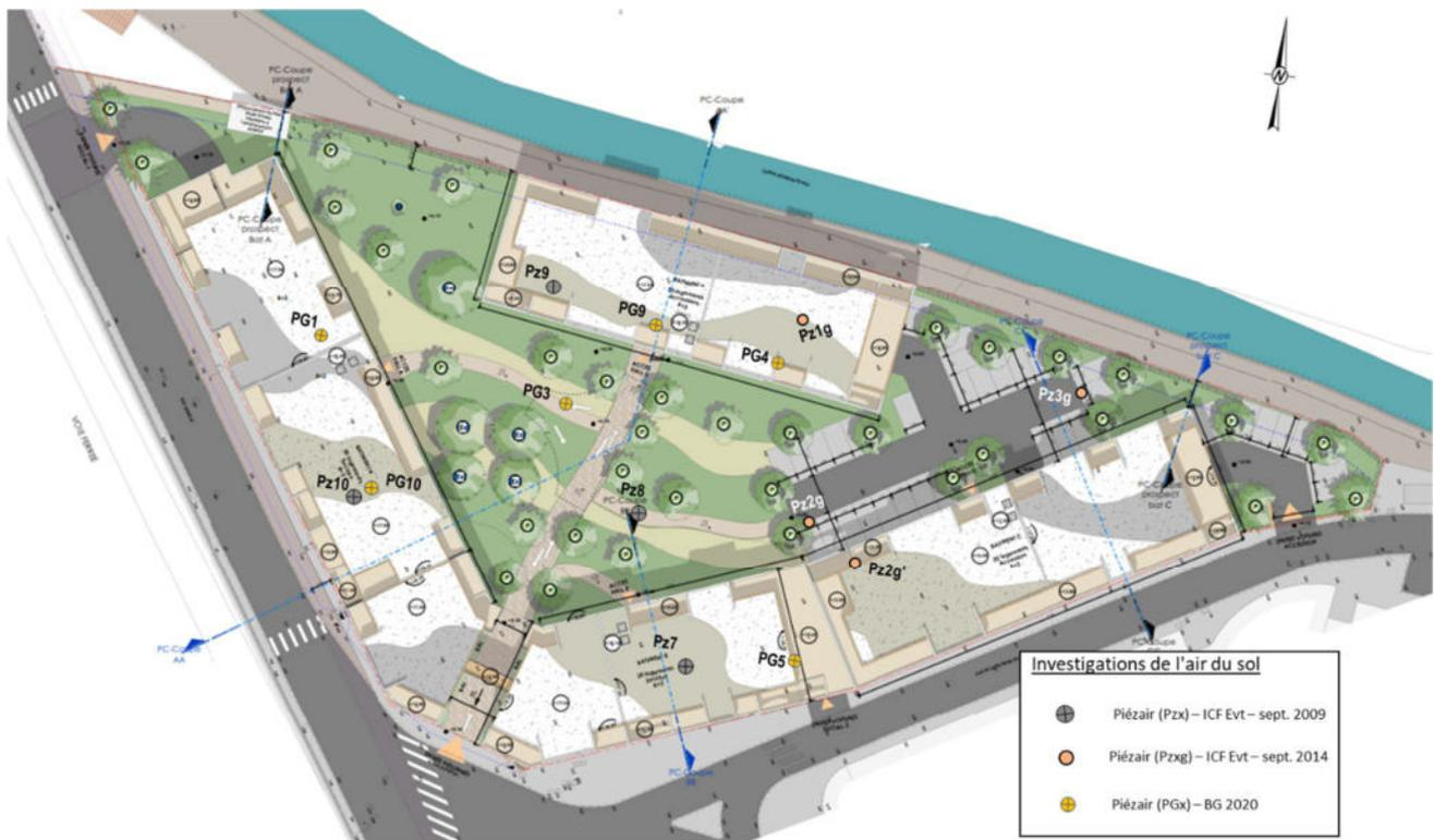
Figure 5 : localisation des points de prélèvement de gaz du sol dans la nouvelle configuration du projet d'aménagement
