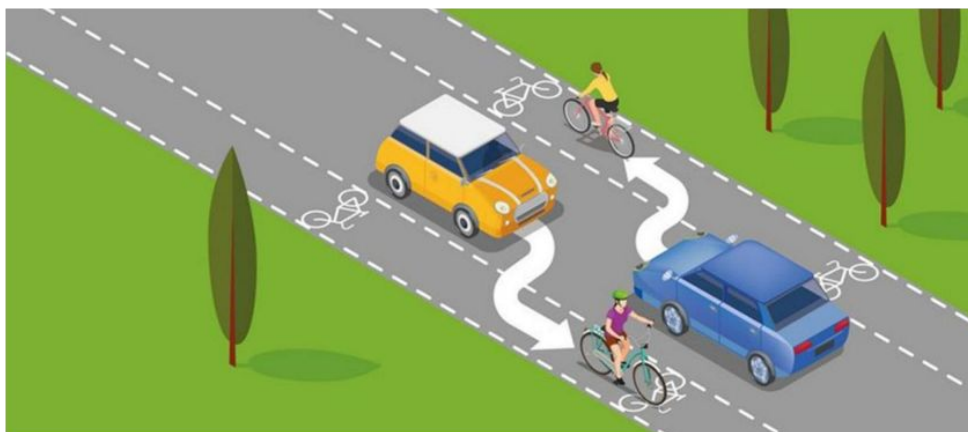
Illustration d'un aménagement en mode « Chaucidou »
